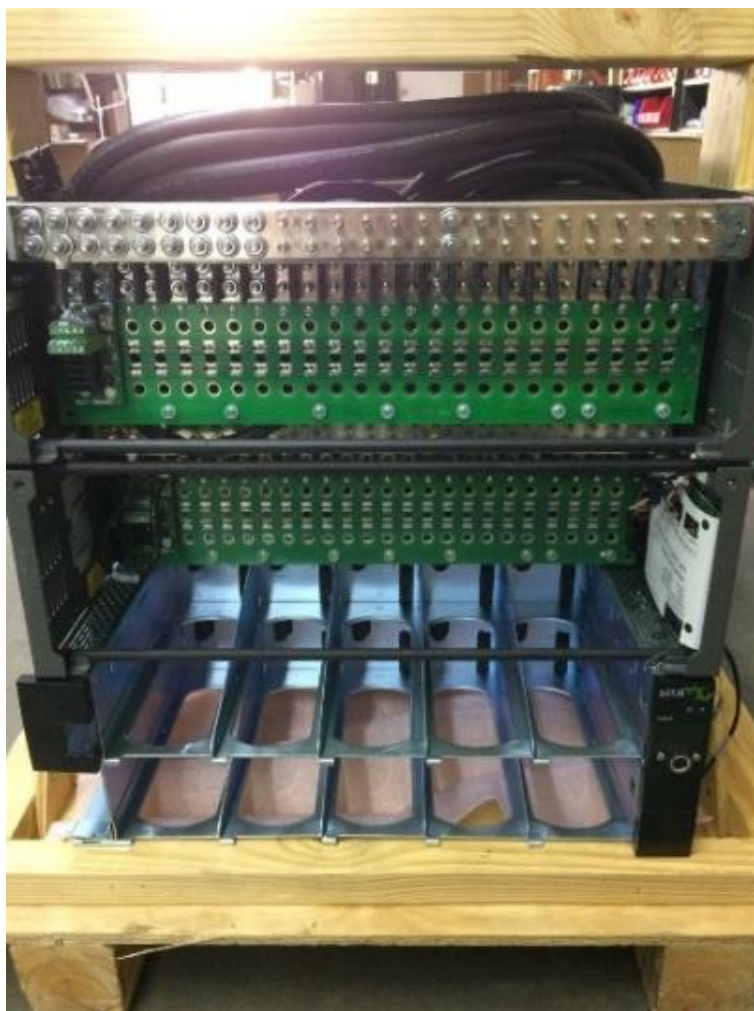
Рисунок 40. Корпус ЭПУ, монтируемой в стойку внешний вид без установленных модулей (пустой).
