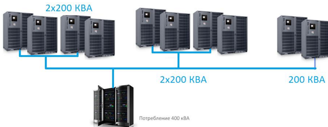
Схема резервирования 2N +1
