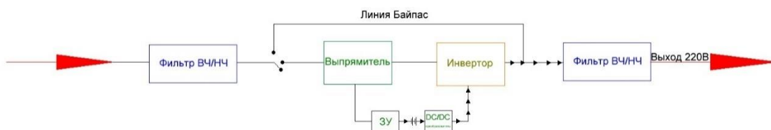
Рисунок 23. ИБП тип On-Line схема работы от АКБ.
