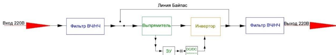
Рисунок 22. ИБП тип On-Line схема работы в нормальном режиме.
