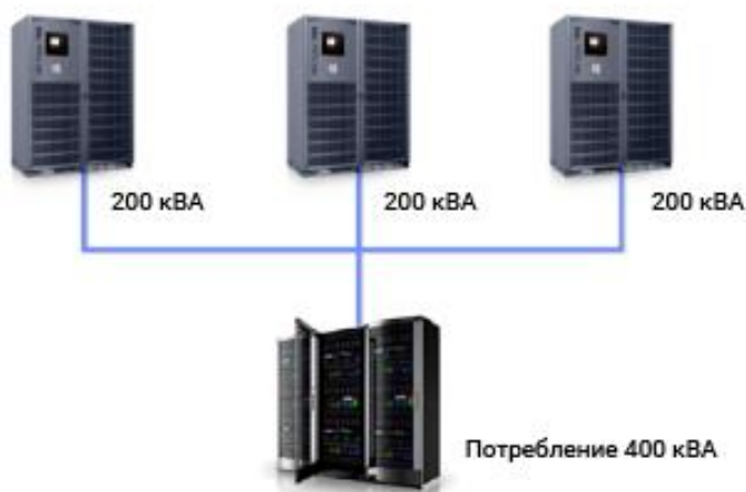
Рисунок 51. Схема резервирования N.
