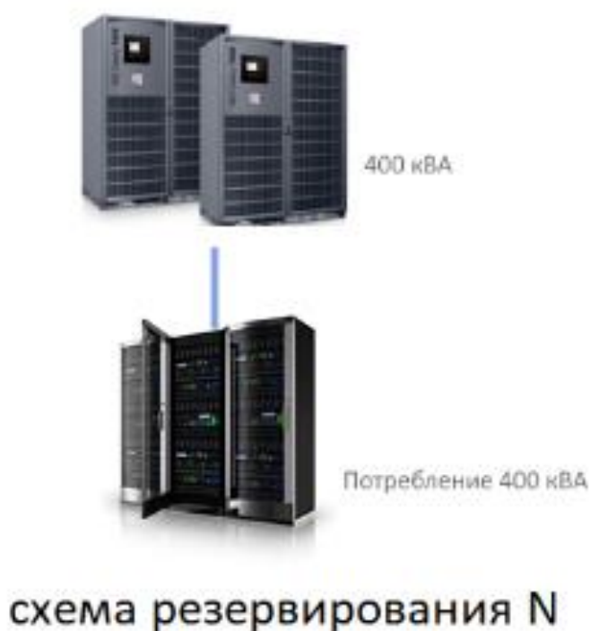
Рисунок 50. Схема резервирования N.
