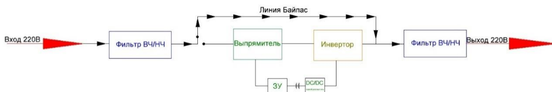
Рисунок 24. ИБП тип On-Line схема работы через байпас.
