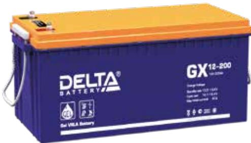
Свинцово-кислотные аккумуляторы серии GX изготовлены по технологии GEL. В качестве электролита используется композитный гель, что обеспечивает устойчивость аккумуляторов DELTA GX к глубоким разрядам и высокую температурную стабильность. Предназначены для работы как в буферном, так и в циклическом режимах.
