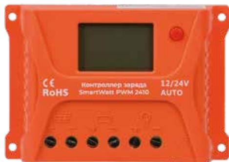
Контроллер заряда SMARTWATT PWM в основе своей работы имеет метод широтно-импульсной модуляции (ШИМ). Этот тип контроллера соединяет солнечную панель с аккумулятором напрямую, его КПД ниже по сравнению с другими контроллерами, но оптимальное ценовое соотношение способствует массовому их применению особенно для небольших автономных СЭС. Важная особенность ШИМ контроллеров – необходимость соблюдения номинальных напряжений солнечных панелей и подключенной к контроллеру аккумуляторной сборки.
