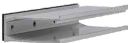
Крепление мини-рейл для монтажа ФЭМ 70x 180 мм. Это основной элемент опорных конструкций, с уплотнителем EDPM в основании. В комплект поставки входят кровельные саморезы.
