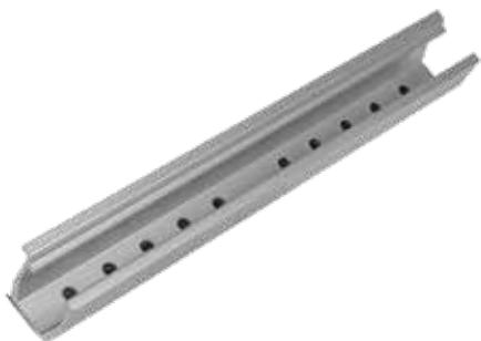
Крепление мини-рейл для монтажа ФЭМ 30x 240 мм. Это основной элемент опорных конструкций, с уплотнителем EDPM в основании. В комплект поставки входят кровельные саморезы.
