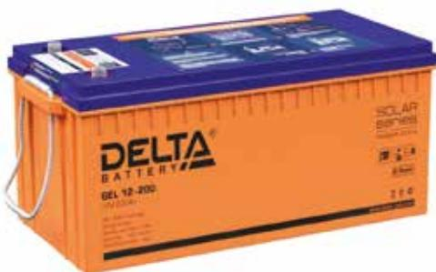
Герметизированные свинцово-кислотные аккумуляторы серии GEL изготовлены по технологии AGM+GEL. Аккумуляторные батареи DELTA серии GEL (от 33 Ач) оснащены встроенным контроллером и LCD дисплеем, на котором отображается статус работы АКБ. Под крышкой аккумулятора имеются дополнительные контейнеры со специализированным раствором, долив которого позволяет продлить срок службы батареи на 15–30%.
